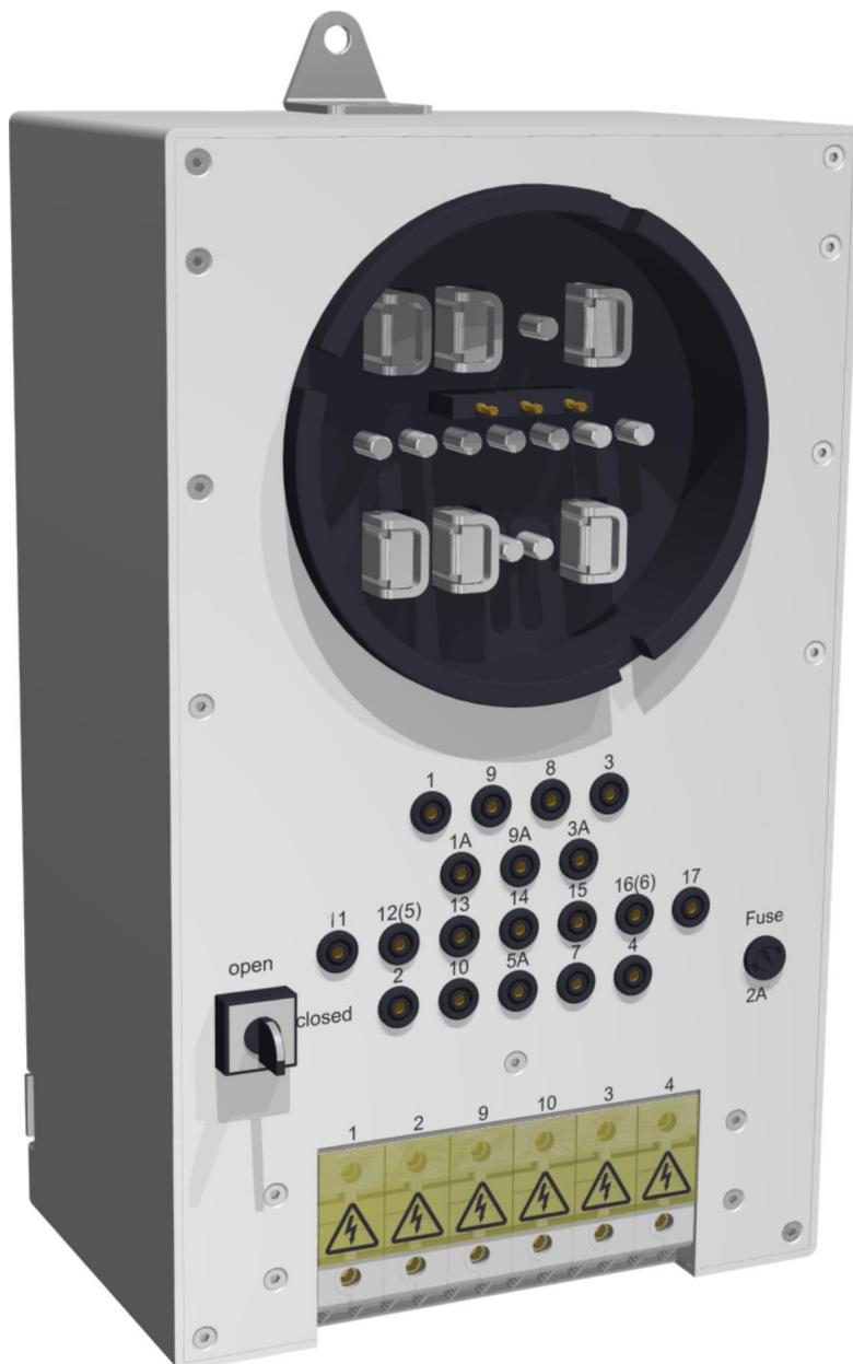
El dispositivo de conexión rápida universal QCD Form S viene utilizado en equipos de ensayo de contadores, y especialmente aplicado allá donde el factor tiempo sea de gran importancia. El dispositivo permite a los contadores de bornera ANSI ser montados con un mecanismo de cierre motorizado y ser conectado rápidamente para los propósitos del ajuste, ensayo y verificación.
